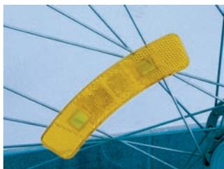
Un catadioptrite est un accessoire en plastique transparent contenant des cellules retro réfléchissantes. Chaque cellule est constitué de 3 mini surfaces réfléchissantes perpendiculaires taillées dans le matériau qui, par le jeu des réflexions multiples, renvoient chaque rayon de lumière dans la direction d'arrivée.
