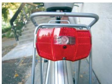
À l'arrière, un feu à diodes rouges est une bonne solution : il est puissant, économe en énergie, fiable, peu coûteux et facile à trouver chez votre vélociste. Néanmoins le faisceau des diodes étant plus étroit, la visibilité latérale n'est pas aussi efficace qu'avec une ampoule.
