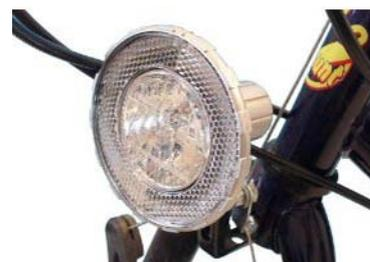
Les diodes deviennent de plus en plus puissantes et prennent progressivement la place des ampoules à incandescence grâce à leur fiabilité et à leur faible consommation d'énergie. Selon les performances (puissance, qualité optique, avec/sans feu de position, solidité des connections), il faut compter de 20 à 100 € pour un ensemble phares avant + arrière.
